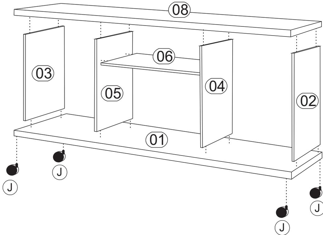
Inicie a montagem parafusando as peças (02),(03),(04) e (05) na base (01) utilizando o parafuso (F)
